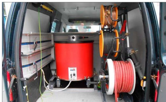
Rys. 1. Zdjęcie wnętrza wozu do diagnostyki kabli
